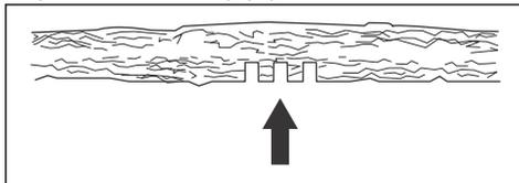
7. Continuez à approfondir les entailles dans l'arbre jusqu'à ce que l'arbre/la branche plie et que la tension soit relâchée.
