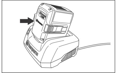
3. Assurez-vous que le témoin de charge vert du chargeur de batterie s'allume. La présence de ce témoin signifie que la batterie est correctement connectée au chargeur de batterie.
