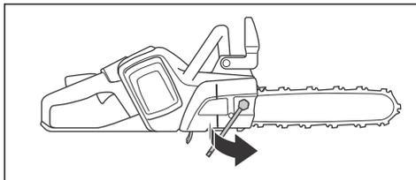
2. Soulevez l'avant du guide-chaîne et tournez la vis de réglage de la tension de chaîne. Utilisez la clé mixte.
