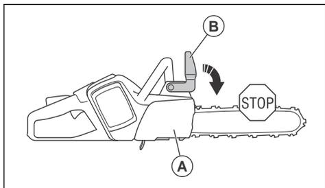
La façon dont le frein de chaîne est engagé dépend de la force du rebond et de la position du produit. En cas de rebond intense lorsque la zone de rebond est très éloignée de vous, le frein de chaîne est engagé par l'inertie relâchée. Si le rebond est faible ou si la zone de rebond est plus proche de vous, vous pouvez engager le frein de chaîne manuellement de la main gauche.
