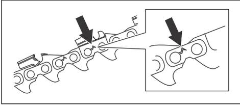
2. Vérifiez que la chaîne peut être courbée facilement. Remplacez la chaîne si elle est rigide.
