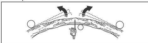
5. Faites une ou plusieurs coupes de profondeur suffisante pour réduire la tension. Coupez au niveau ou à proximité du point de tension maximale. Faites en sorte que l'arbre ou la branche se brise au niveau du point de tension maximale.
