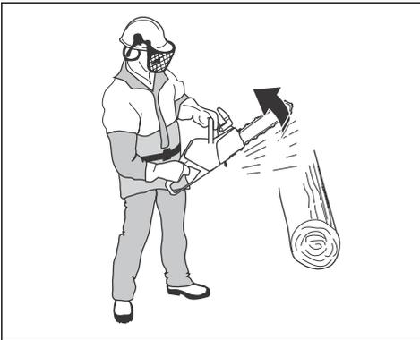
Un rebond ne peut se produire que lorsque la zone de rebond du guide-chaîne entre en contact avec un objet. Ne laissez pas la zone de rebond entrer en contact avec aucun objet.
