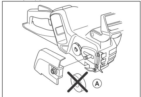
3. Placez le guide-chaîne au-dessus du boulon du guide-chaîne. Guidez le guide-chaîne dans sa position la plus en arrière possible. Soulevez la chaîne de sciage au-dessus du pignon d'entraînement et placez-la dans la rainure du guide-chaîne. Commencez par le bord supérieur du guide-chaîne.
