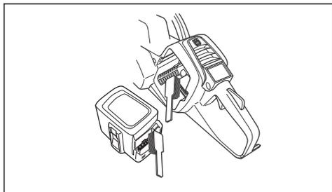
3. Vérifiez que la batterie n'est pas endommagée et ne présente aucun défaut apparent (fissure, etc.).
