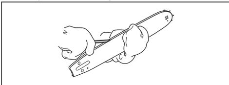
4. Examinez l'usure de la rainure du guide-chaîne. Remplacez le guide-chaîne si nécessaire.
