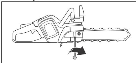
4. Serrez l'écrou du guide-chaîne à l'aide de la clé mixte et soulevez en même temps l'extrémité avant du guide-chaîne.
