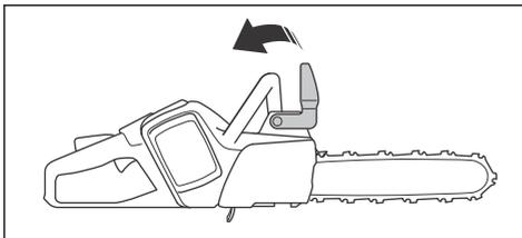
2. Desserrez l'écrou du guide-chaîne et retirez le couvercle du pignon d'entraînement et la bague de transport (A).
